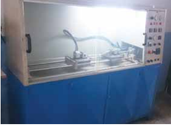
Flexible Çelik Bağlantı Test Makinası Braided Flexible Hose Tension and Pressure
